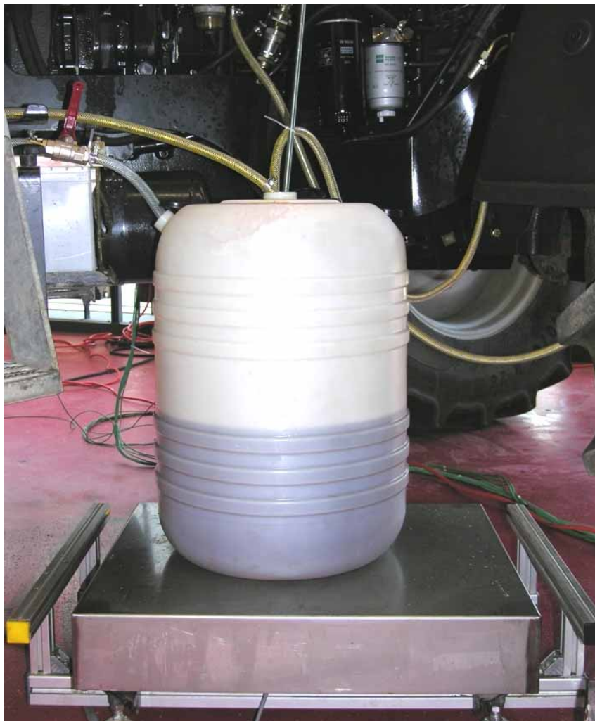
Abbildung 4: Aufbau zur Bestimmung des Kraftstoffverbrauchs mittels Wägung des Versuchskraftstoffbehälters
